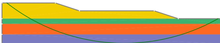
Figura 5.14 – Principais resultados e superfície crítica de ruptura (Variabilidade espacial :  $\delta x = 30m$ ;  $\delta y = 30m$ ).
