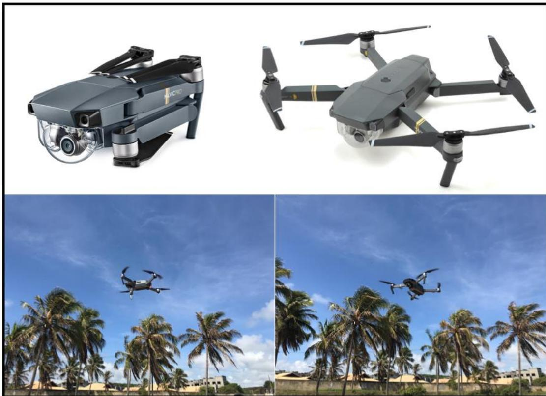
Figura 3.2 – Drone DJI Mavic Pro utilizado para a fotogrametria da praia de Barra de Tabatinga/RN.
