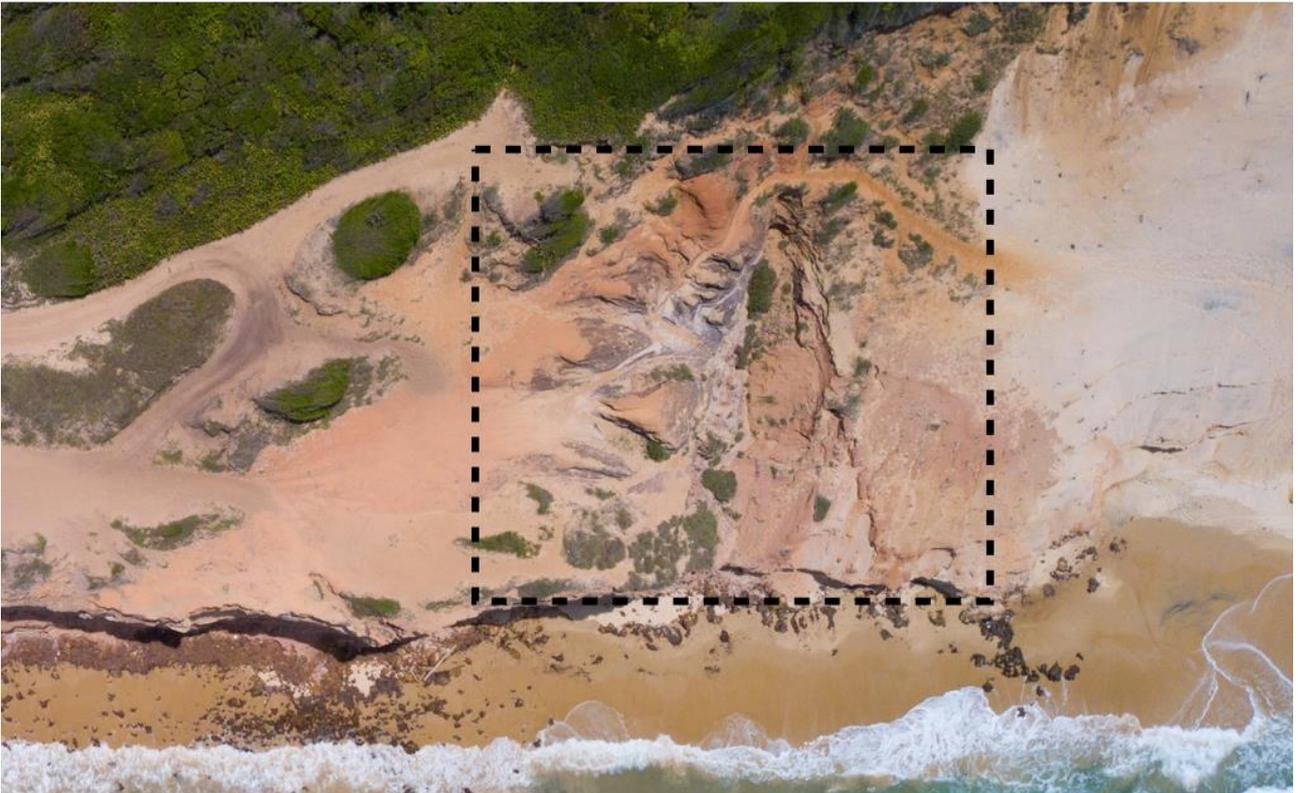
Figura 3.28 – Formação de ravina no topo da falésia, devido a erosão pluvial. Destaque na Figura para os caminhos preferenciais das águas de chuvas até o ponto mais crítico - Praia de Tabatinga/RN (Foto: Daniel Herrera).
