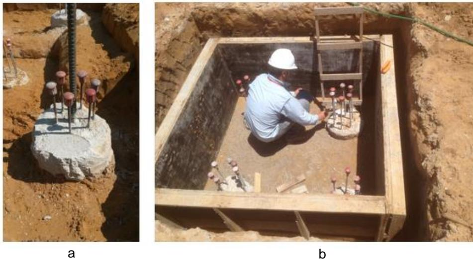
Figura 65 – a) topo de uma estaca preparada. b) execução do ensaio PIT.
