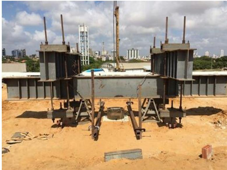
Figura 63 – Prova de carga montada.
