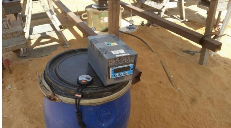
Figura 61 – Data logger para leitura dos esforços aplicados.
