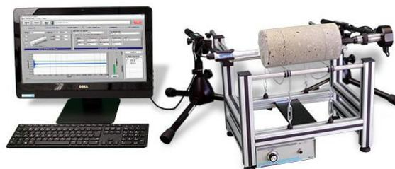
Figura 4.6 - Sistema Sonelastic<sup>®</sup> para amostras de médio porte caracterizando um cilindro de concreto no modo de vibração longitudinal (ATPC Engenharia Física, 2017)
