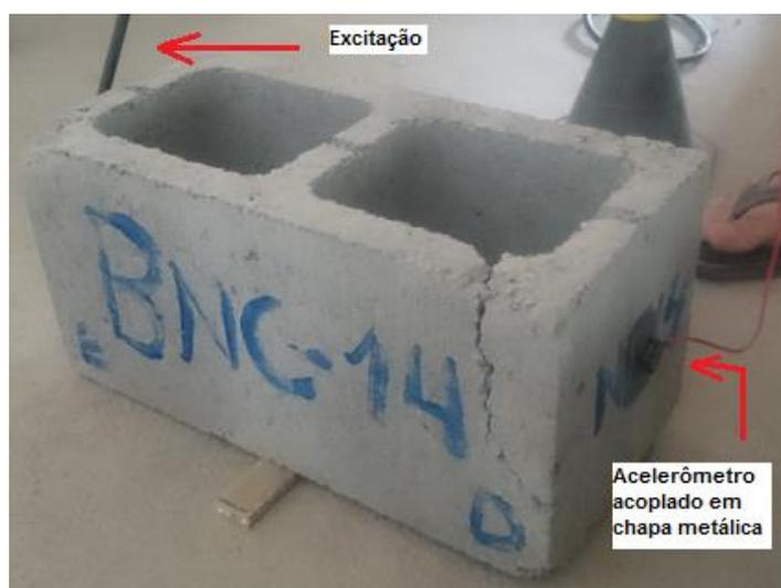
Figura 4.10 – Ensaio da Técnica de Excitação por Impulso no BNC14 com o uso do acelerômetro
