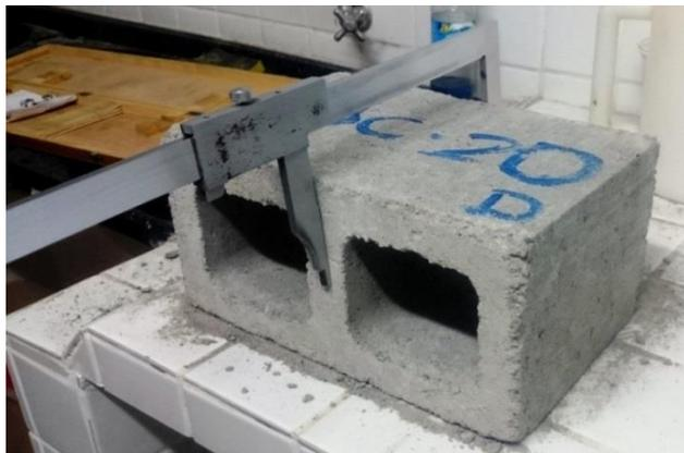
Figura 4.5 – Aferição das dimensões do BC20 da família M-15
