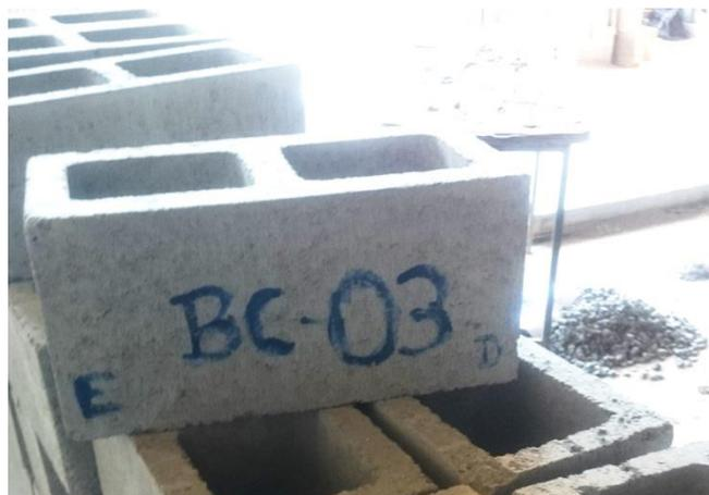
Figura 4.2 – Identificação de blocos conformes da família M-20
