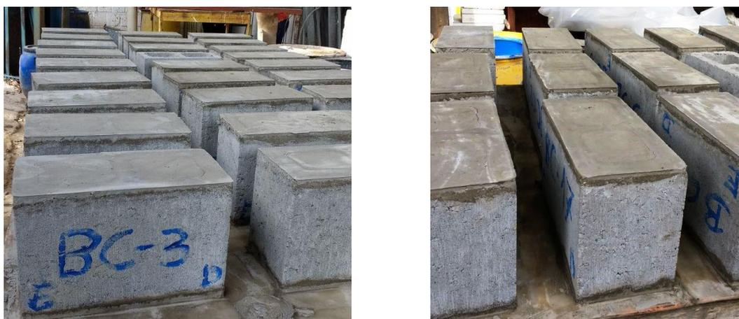
Figura 4.13 – Capeamento dos blocos conformes da família M-15 para realização dos ensaios à compressão
