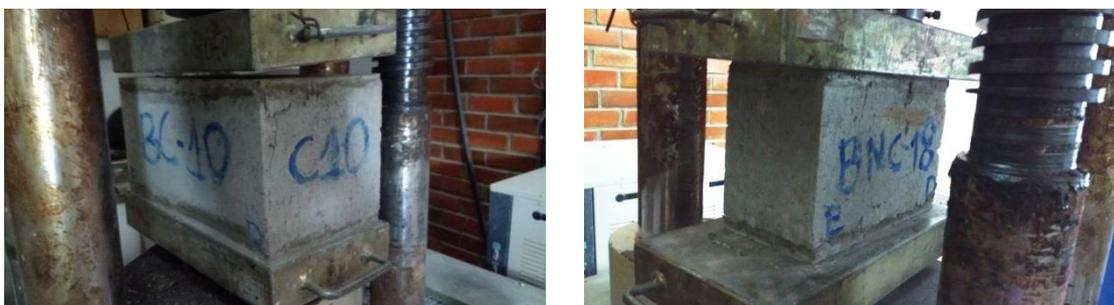
Figura 4.14 – Ensaio à compressão em bloco conforme 10 da família M-20 e bloco não conforme 18 da família M-15, respectivamente.
