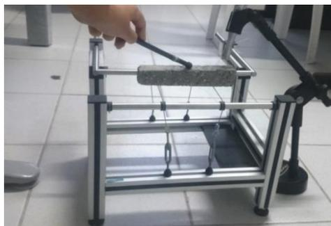
Figura 4.7 – Aparato do ensaio no prisma retirado da parede transversal do bloco da família M-15 para obtenção do módulo de elasticidade no modo transversal
