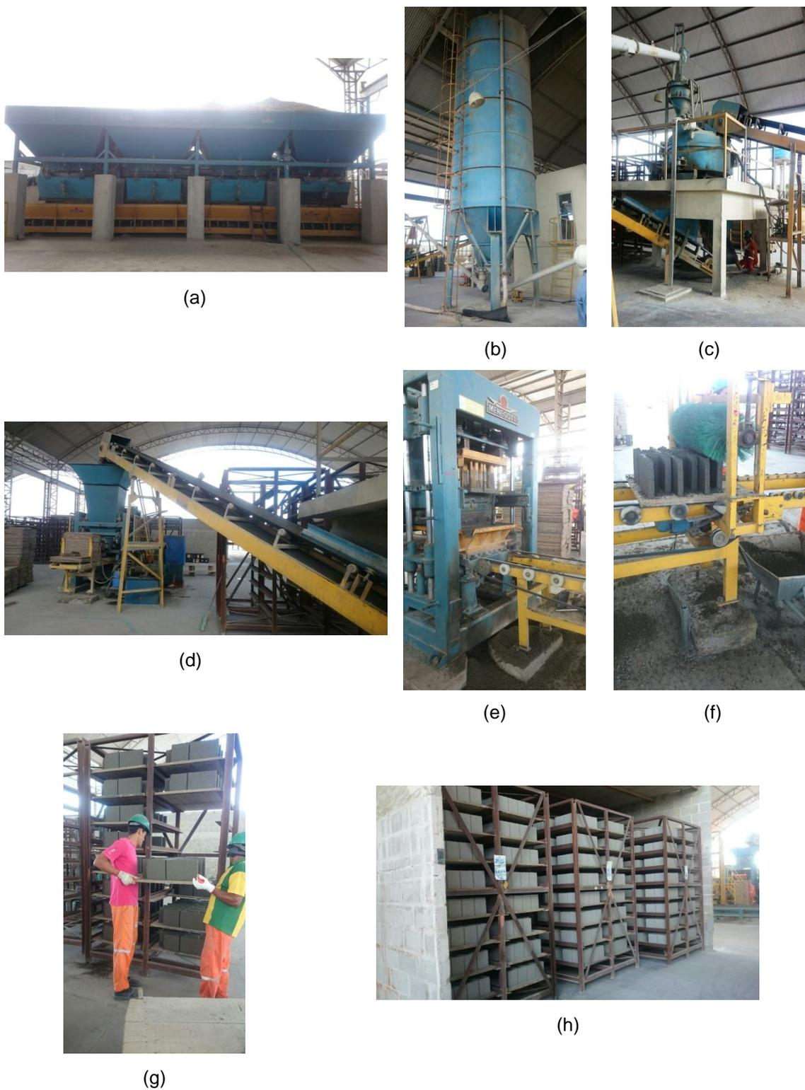
Figura 2.5 – Produção de blocos de concreto para alvenaria estrutural (Autor, 2018)
