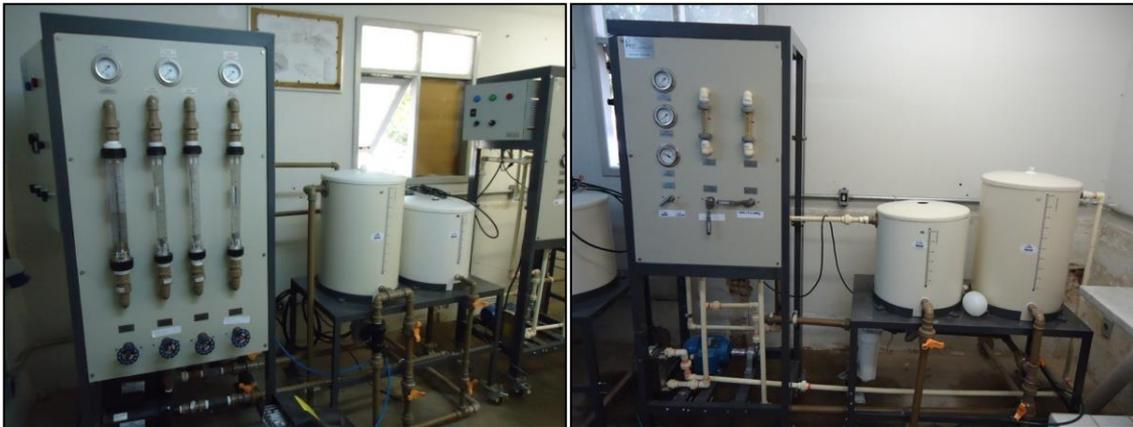
Figura 2. Sistema de filtração da UF (esquerda) e NF e OI (direita).
