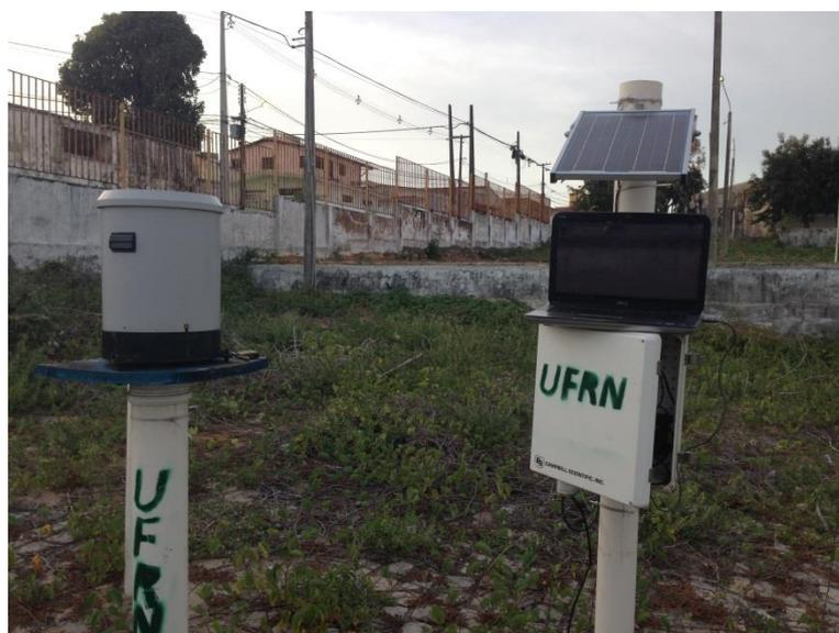
**Figura 3.4** – Estação pluviométrica automática do FLOCA
