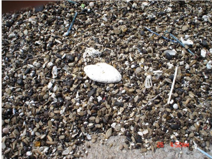
**Figura 5.5** Resíduos sólidos existentes no lodo sobrenadante com destaque para a grande quantidade de sementes.
