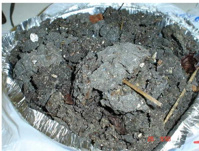
**Figura 5.10** Amostras de lodo retirada do leito de secagem para realização de análises.
