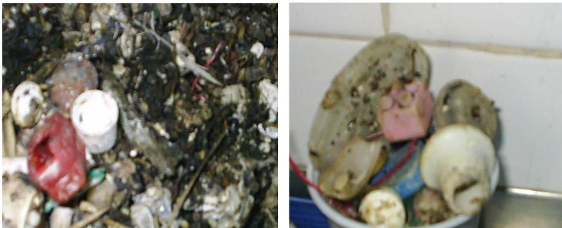
**Figura 5.6** Tampas de pedaços de material plástico existentes no lodo sobrenadante.
