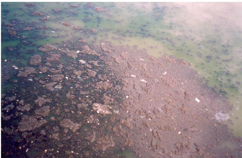
**Figura 5.3** Vista de flocos de lodo mais aglutinados devido à falta de remoção da superfície do reator.
