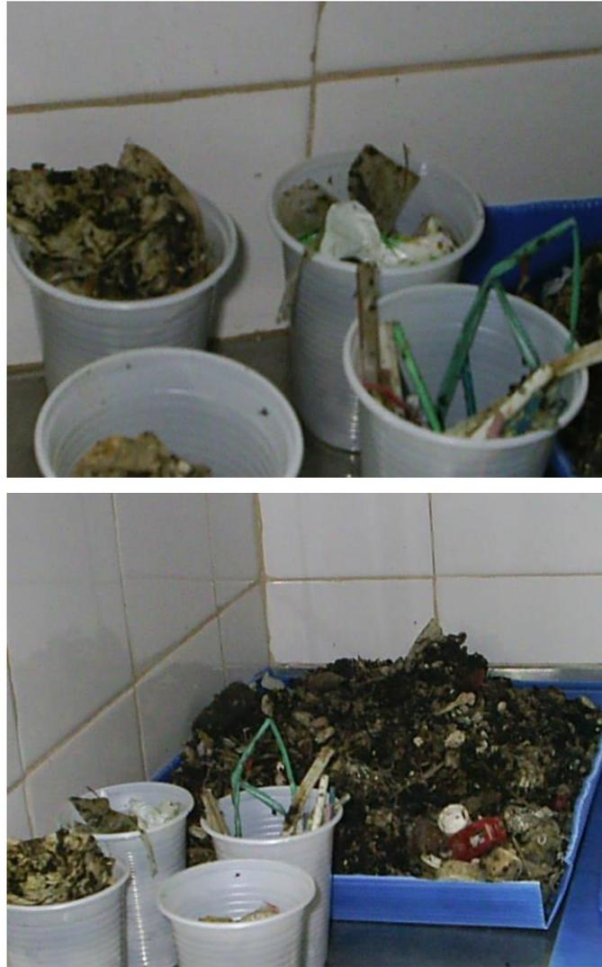
**Figura 5.7** Canudos e outras hastes plásticas, preservativos e restos de absorventes existentes no lodo sobrenadante.
