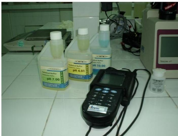
**FIGURA 21:** Foto do Multifunção Portátil, das soluções calibradoras para o pH (à esquerda) e da solução ácida KCl (à direita).
