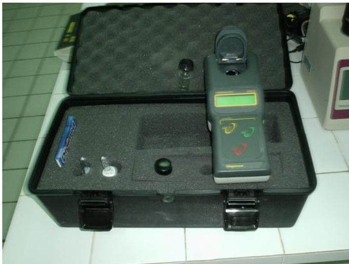
**FIGURA 22: Foto do Turbidímetro Portátil, com sua maleta de campo e soluções calibradoras.**
