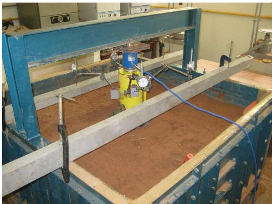
Figura 43 - Fixação e posicionamento dos extensômetros em relação às vigas de referência.
