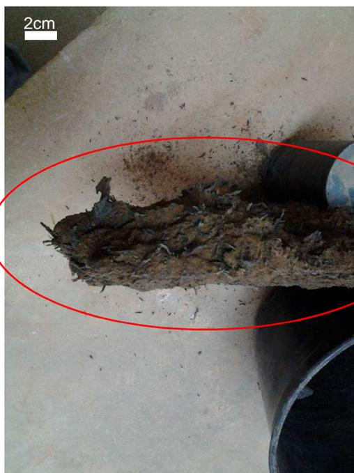
Figura 62 – Parcela do compósito retirada da camada.
