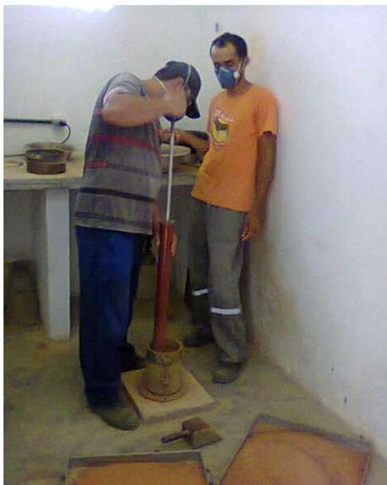
Figura 44 - Compactação do corpo-de-prova.
