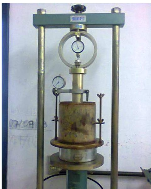
Figura 46 - Corpo-de-prova preparado e instalado na prensa.
