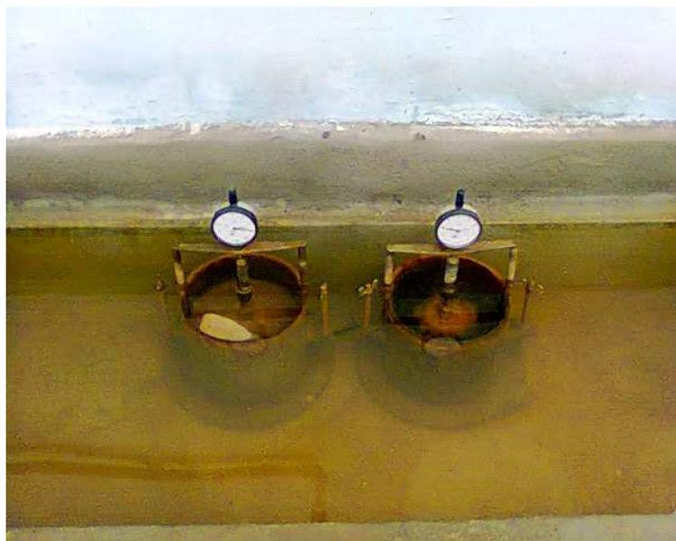
Figura 45 - Corpo-de-prova imerso em tanque com água para retirar as medidas de expansão.
