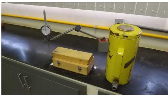
Figura 38 - Extensômetros magneticamente ligado ao cilindro hidráulico.
