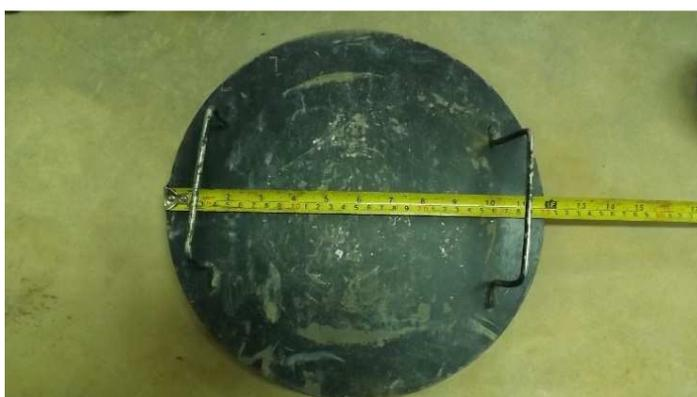
Figura 36 - Placa metálica rígida com diâmetro de  $0,30\text{m}$ .
