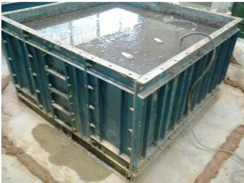
Figura 35 – Aterro submetido à saturação.
