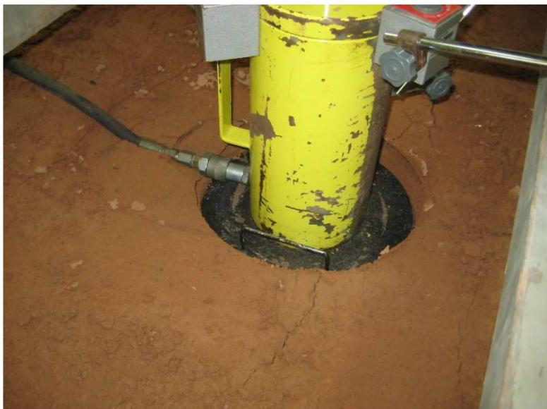
Figura 69 – Final do ensaio para o solo de referência ( $\chi=0\%$ ). Placa cravada no aterro.
