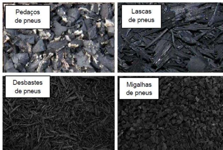
Figura 3 -Dimensões de resíduo de pneus segundo ASTM 6270 (EDINÇLILER et al., 2010)
