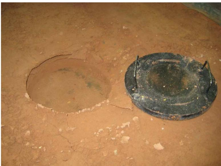
Figura 70 – Forma do solo de referência após o ensaio.
