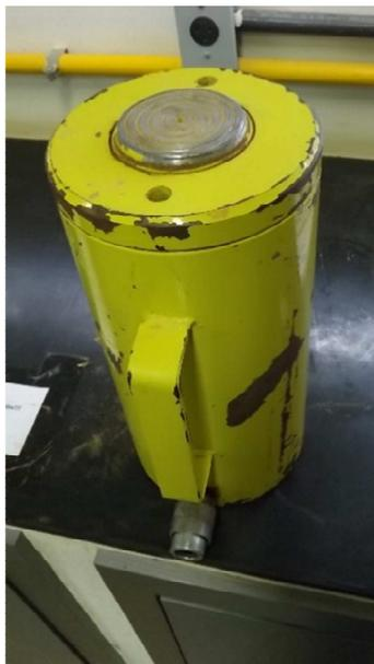
Figura 37 - Cilindro hidráulico com capacidade de 50 toneladas.
