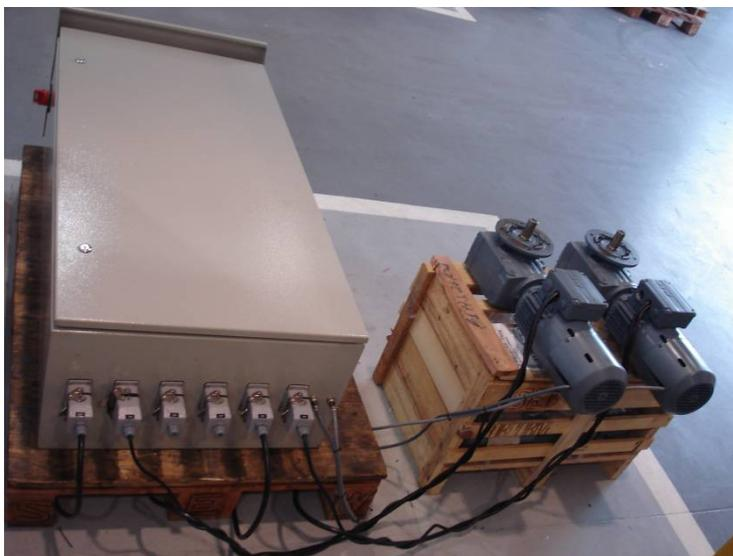
**Figura 8. Sistema de acionamento**
