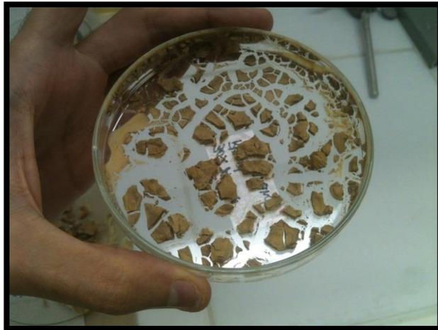
Figura 12: Argila obtida após 48h de secagem na estufa.
