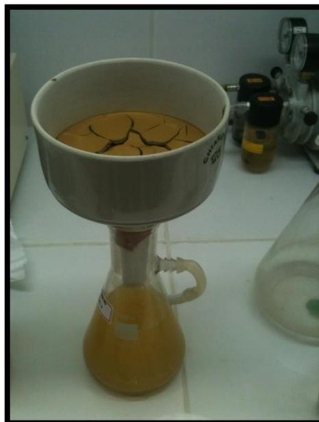
Figura 11: Solução sendo filtrada com auxílio de um a bomba de vácuo.
