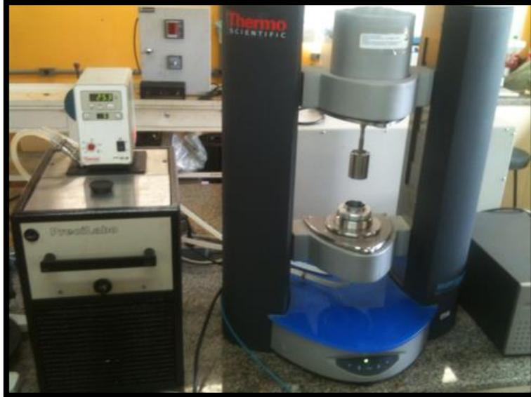
Figura 14: Reômetro Mars da *Thermo Scientific*.
