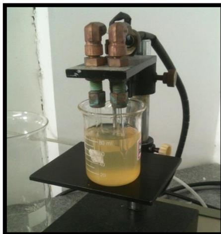
Figura 13: Tensiômetro *SensaDyn*.
