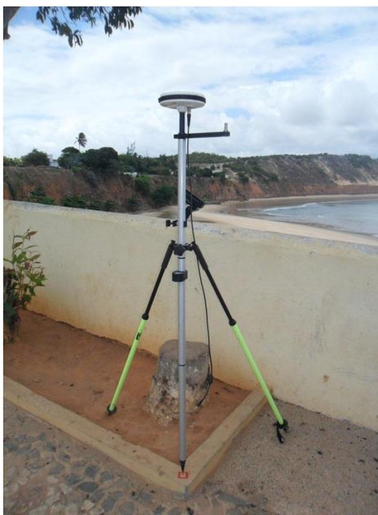
**Figura 4.2** Receptor GPS com base fixa no topo da falésia.
