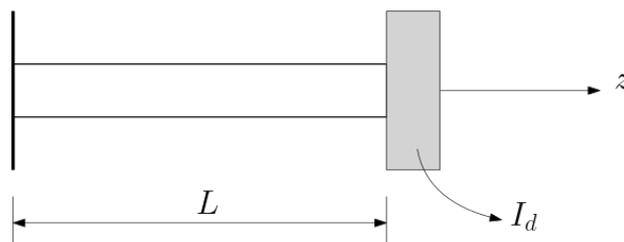
Figura 3. Eixo fixo em  $z = 0$  e conectado a um disco em  $z = L$ .
