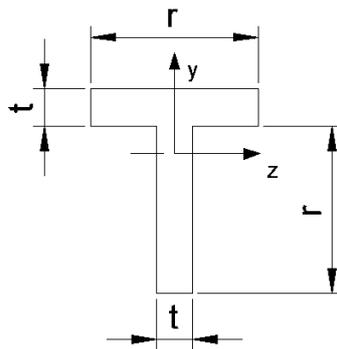
Figura 7. Seção transversal da Viga articulada
