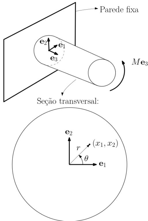
Figura 1. Eixo de raio  $R$  e comprimento  $L$  submetido a um momento externo de magnitude  $M$ . Os eixos de referência são definidos pelos vetores fixos, unitários e ortonormais  $\{e_i\}$ .
