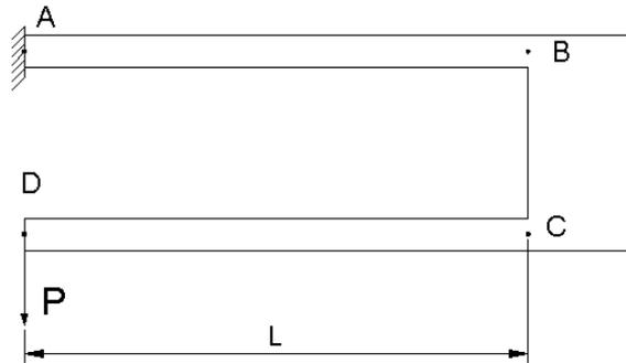
Figura 4. Estrutura em flexão engastada no ponto A e carregada com força  $P$  na extremidade D
