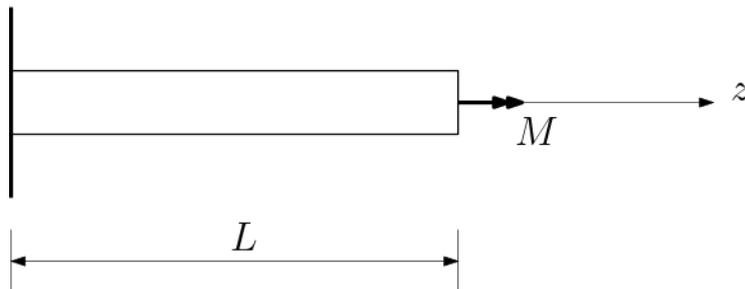
Figura 2. Eixo fixo em  $z = 0$  e sujeito ao momento torcional externo  $M$  em  $z = L$ .
