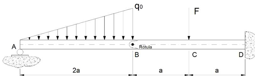
Figura 6. Viga articulada com suas condições de apoio e carregamentos
