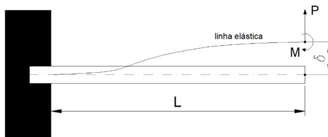
Figura 5. Viga engastada-livre com aplicação da Força  $P$  e Momento  $M$  em sua extremidade livre
