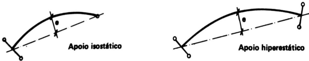
Figura 2.4 – Sistema de apoios para pontes curvas em um só vão. Fonte: Leonhardt (1979)
