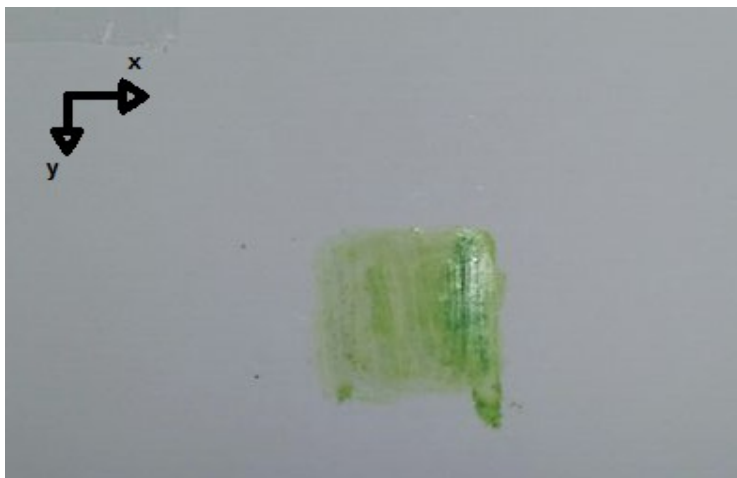
Figura 35: Resultado do ensaio de percurso completo de quadrado de lado 9 milímetros.
