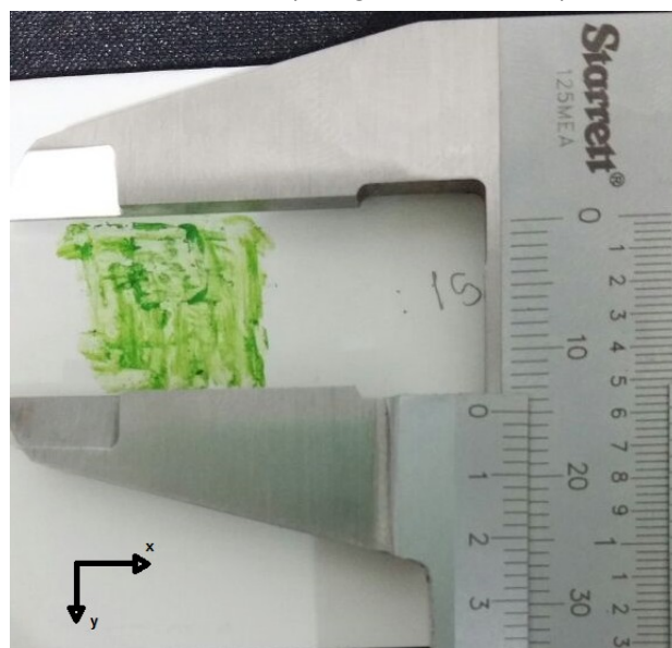
Figura 40: Resultado da medição do eixo Y do ensaio de percurso completo de um quadrado de lado de 15 milímetros. (Imagem Ilustrativa)
