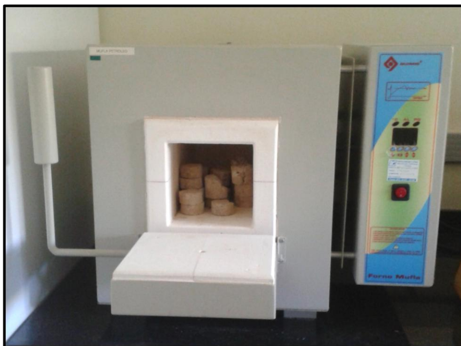
Figura 3.1: Amostras de calcário em calcinação na mufla.
