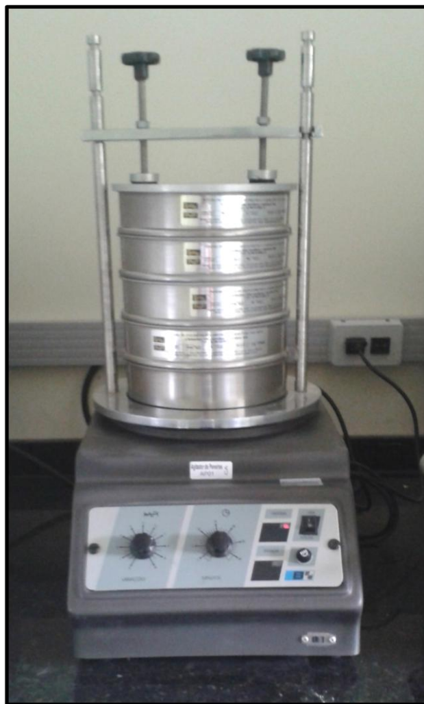
Figura 3.2: Amostras de calcário sendo peneiradas.
