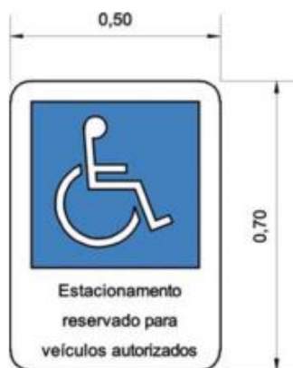
Figura 7: Sinalização em espaço interno
