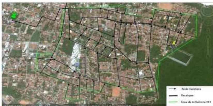
Sistema de Esgotamento Sanitário na Vila de Ponta Negra - Estação Elevatória 2
